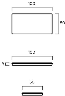
**MATERIAL:** Hormigón prefabricado hidrofugado armado.
