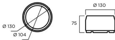
**MATERIAL:** Hormigón prefabricado hidrofugado armado.
