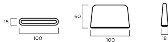
**MATERIAL:** Hormigón prefabricado hidrofugado armado.
