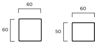
**MATERIAL:** Hormigón prefabricado hidrofugado sin armadura.
