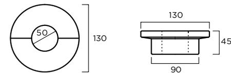
**MATERIAL:** Hormigón prefabricado hidrofugado armado.
