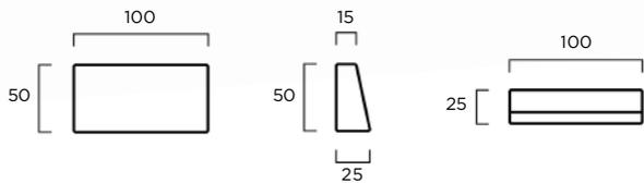
**MATERIAL:** Hormigón prefabricado hidrofugado armado.
