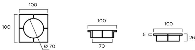
**MATERIAL:** Hormigón prefabricado hidrofugado armado.
