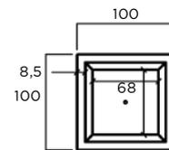
**MATERIAL:** Hormigón prefabricado hidrofugado armado.
