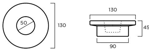
**MATERIAL:** Hormigón prefabricado hidrofugado armado.
