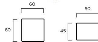
**MATERIAL:** Hormigón prefabricado hidrofugado sin armadura.
