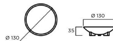
**MATERIAL:** Hormigón prefabricado hidrofugado armado.
