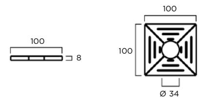
**MATERIAL:** Hormigón prefabricado hidrofugado armado.
