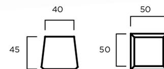
**MATERIAL:** Hormigón prefabricado hidrofugado sin armadura.
