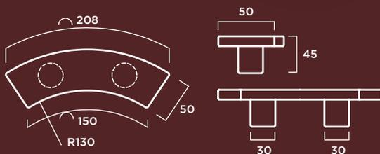
**MATERIAL:** Hormigón prefabricado hidrofugado con armadura de acero zincado.
