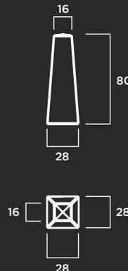
**MATERIAL:** Hormigón prefabricado hidrofugado con armadura de acero.
