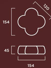
**MATERIAL:** Hormigón prefabricado hidrofugado con armadura de acero zincado.
