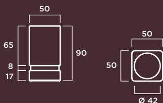
**MATERIAL:** Hormigón prefabricado hidrofugado sin armadura.
