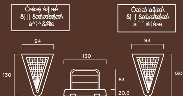
**MATERIAL:** Base de hormigón prefabricado hidrofugado con armadura de acero.
