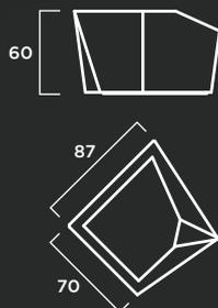
**MATERIAL:** Hormigón prefabricado hidrofugado con armadura de acero zincado. Revestimiento interior de fibra de vidrio y resina acrílica.
