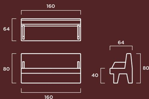
**MATERIAL:** Hormigón prefabricado hidrofugado con armadura de acero zincado. Apoyabrazos de acero inoxidable AISI304.
