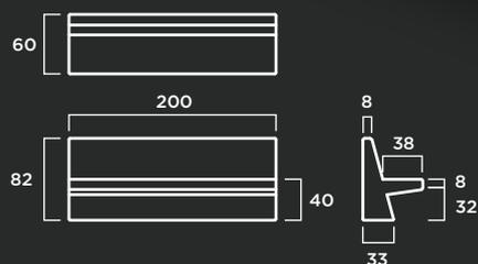
**MATERIAL:** Hormigón prefabricado hidrofugado con armadura de acero zincado.
