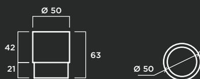
**MATERIAL:** Hormigón prefabricado hidrofugado sin armadura.
