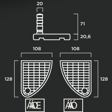
**MATERIAL:** Base de hormigón prefabricado hidrofugado con armadura de acero.
