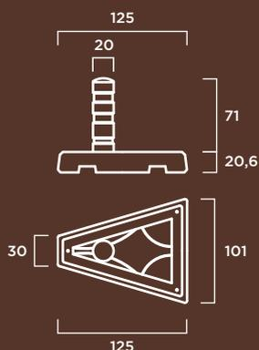
**MATERIAL:** Base de hormigón prefabricado hidrofugado con armadura de acero.
