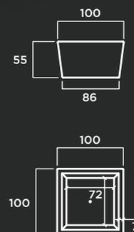
**MATERIAL:** Hormigón prefabricado hidrofugado con armadura de acero zincado. Revestimiento interior de fibra de vidrio y resina acrílica.
