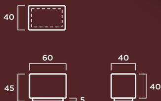
**MATERIAL:** Hormigón prefabricado hidrofugado (sin armadura).
