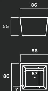
**MATERIAL:** Hormigón prefabricado hidrofugado con armadura de acero zincado. Revestimiento interior de fibra de vidrio y resina acrílica.
