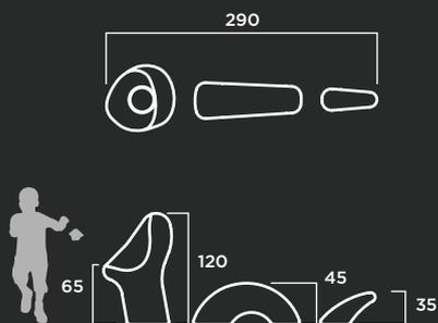
**MATERIAL:** Hormigón prefabricado hidrofugado con armadura de acero zincado.
