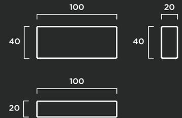
**MATERIAL:** Hormigón prefabricado hidrofugado con armadura de acero. Con casquillo roscado para elevación.
