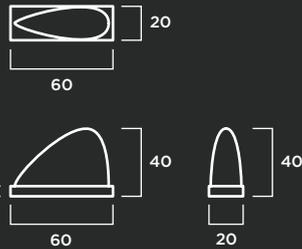
**MATERIAL:** Hormigón prefabricado hidrofugado con armadura de acero.
