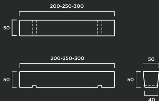
**MATERIAL:** Hormigón prefabricado hidrofugado con armadura de acero zincado.
