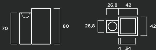
**MATERIAL:** Hormigón prefabricado hidrofugado sin armadura.
