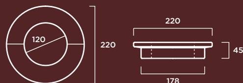
**MATERIAL:** Hormigón prefabricado hidrofugado con armadura de acero zincado. Compuesto por dos piezas.
