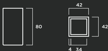
**MATERIAL:** Hormigón prefabricado hidrofugado sin armadura.
