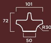
**MATERIAL:** Hormigón prefabricado hidrofugado con armadura de acero zincado.
