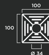
**MATERIAL:** Hormigón prefabricado hidrofugado con armadura de acero.
