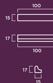
**MATERIAL:** Hormigón prefabricado hidrofugado (sin armadura).
