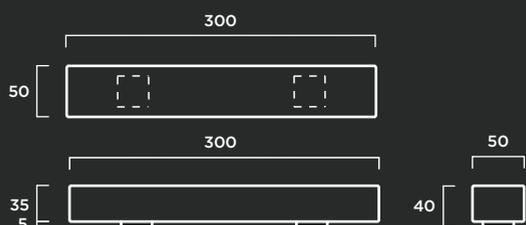
**MATERIAL:** Hormigón prefabricado hidrofugado con armadura de acero zincado.
