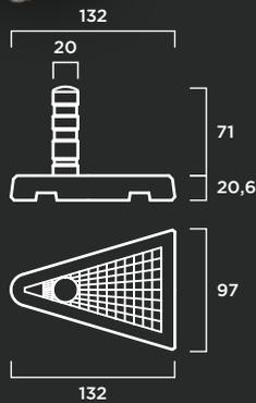
**MATERIAL:** Base de hormigón prefabricado hidrofugado con armadura de acero.
